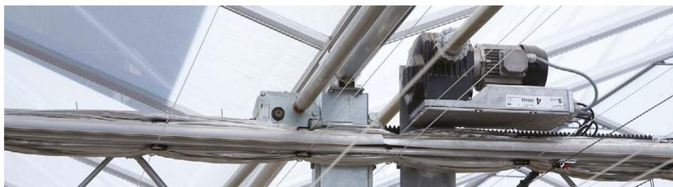
Les motoréducteurs Ridder RW présentés dans ce catalogue peuvent être fournis avec des commandes intégrées, les commandes Ridder LogicLink. Cela crée des entraînements complets, où les composants mécaniques et les composants de commande sont coordonnés de façon optimale. La combinaison de motoréducteurs et de commandes LogicLink offre aussi de nouvelles opportunités, difficiles à rencontrer avec des systèmes de commande conventionnels, non intégrés.
