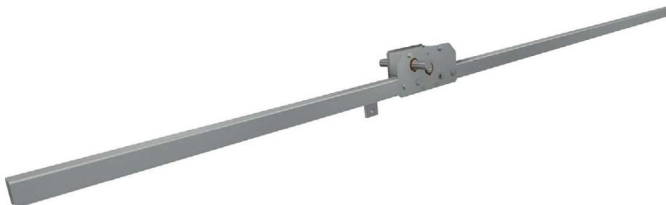
L'entraînement à crémaillère TR520I est un entraînement sans maintenance, conçu pour l'ouverture et la fermeture de fenêtres d'aération dans les serres Venlo, qui sont commandés par un système à air oscillant. En combinaison avec un motoréducteur RW de Ridder, l'entraînement à crémaillère TR520I contribue à un climat optimal dans une serre grâce au positionnement précis des fenêtres d'aération.
