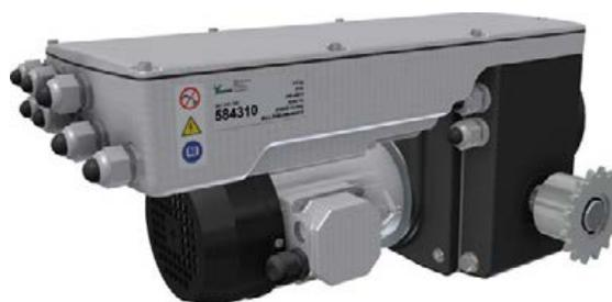
La commande LogicLink de Ridder est un système prêt à l'emploi et facile à utiliser pour l'installation et la commande des motoréducteurs RW dans les deux sens de rotation. Pour l'intégration des composants, la commande est montée sur le motoréducteur, le circuit imprimé de la commande étant coulé avec des relais statiques. Cela lui confère une classe de protection élevée.
