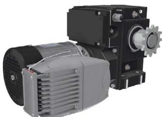
Le set de vis sans fin des motoréducteurs RW1000/1400F garantit le blocage de l'arbre d'entraînement quand l'entraînement ne fonctionne pas. La combinaison de transmissions à engrenages et à denture hélicoïdale parfaitement assorties les unes aux autres résulte en un entraînement très peu bruyant.
