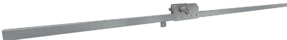
L'entraînement à crémaillère TR25I/46 est un entraînement sans maintenance, conçu pour l'ouverture et la fermeture de fenêtres d'aération dans les serres Venlo, qui sont commandés par un système à air oscillant. En combinaison avec un motoréducteur RW de Ridder, l'entraînement à crémaillère TR25I/46 contribue à un climat optimal dans une serre grâce au positionnement précis des fenêtres d'aération.
