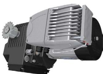
La transmission à denture hélicoïdale autobloquante des motoréducteurs RW800F garantit le freinage de l'arbre d'entraînement lorsque l'entraînement est arrêté. La combinaison de transmissions à pignons et à denture hélicoïdale assorties produit une transmission mécanique très silencieuse.
