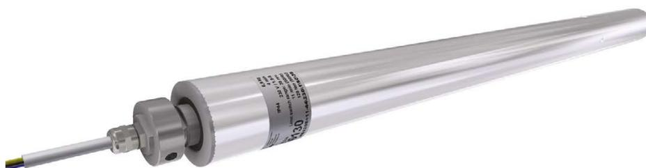
Le moteur tubulaire Ridder RB120E<sup>plus</sup>, sans maintenance, est un entraînement destiné à entraîner des systèmes de stores à enrouleur (stores à enrouleur de toiture PAS AUTORISÉ, reportez-vous au RPR PowerRoller) dans les serres et des étables. Le moteur tubulaire est intégré, de série, dans un tube en aluminium de 63 mm de diamètre (épaisseur 1,5 mm) et est destiné aux tubes enrouleurs de 63 mm. De par son intégration, le moteur tubulaire peut être entièrement rembobiné.
