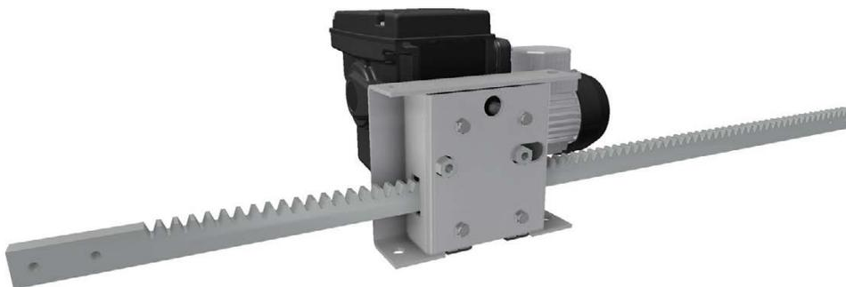
L'entraînement à crémaillère TRA520, monté sur des motoréducteurs RW45TRA ou RW240TRA, est un entraînement qui nécessite peu d'entretien et est destiné à entraîner des systèmes d'aération et de levage dans des serres et des étables. L'entraînement à crémaillère TRA520, fixé sur un motoréducteur RW de Ridder, permet un positionnement très précis du système entraîné. Les coulisseaux de l'entraînement à crémaillère TRA520 permettent une extension et une rétraction stables de la crémaillère.
