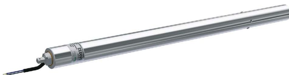
Le moteur tubulaire Ridder RB50E<sup>plus</sup>, sans maintenance, est un entraînement destiné à entraîner des systèmes de stores à enrouleur (stores à enrouleur de toiture PAS AUTORISÉ, reportez-vous au RPR PowerRoller) dans les serres et des étables. Le moteur tubulaire est intégré, de série, dans un tube en aluminium de 50 mm de diamètre (épaisseur 1,5 mm) et est destiné aux tubes enrouleurs de 50 mm. De par son intégration, le moteur tubulaire peut être entièrement rembobiné.
