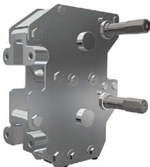
Le RackDrive810 possède un étage de réduction simple ( $i = 2,76$ ) et des pignons d'entraînement trempés pour les crémaillères. Le couple moteur est efficacement converti en des forces de crémaillère de maximum 5200 N (RRD810-523), 10000 N (RRD810-1003) ou 13000 N (RRD810-1303). Les coulisseaux permettent une extension et une rétraction stables des crémaillères. Les entraînements à crémaillère RackDrive810 sont faciles à entretenir grâce à des graisseurs installés aux points stratégiques.
